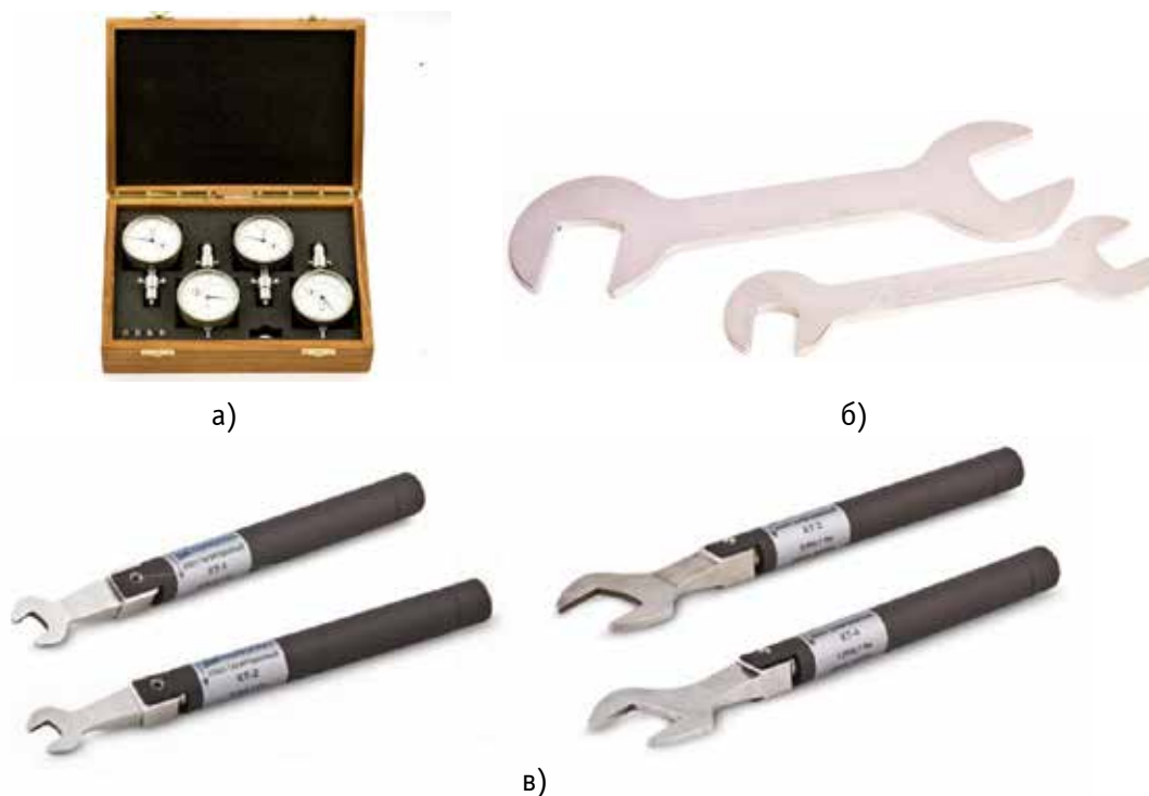
Рис. 31. Набор измерителей присоединительных размеров (а), поддерживающие (б) и тарированные ключи (в)
