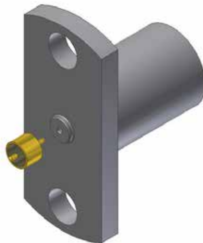
Рис. 7. Приспособление для пайки гермоввода для устройств, использующих фланцевый корпус КМПП с двумя крепежными отверстиями (ЖНКЮ.713424.001)
