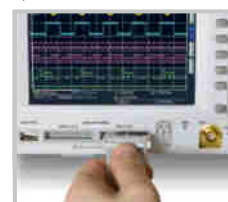
Многоконтактный соединитель для подключения логического пробника
