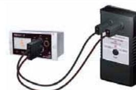
E6042323 Индикатор короткого замыкания SIGMA. Обнаруживает короткие замыкания в распределительных сетях среднего напряжения. Состоит из дисплейного блока, устанавливаемого в вырезе панели, и трёх трансформаторов тока для обнаружения тока короткого замыкания.
