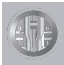
Рис. 4-7. Разъединитель-заземлитель в положении «заземлено»
