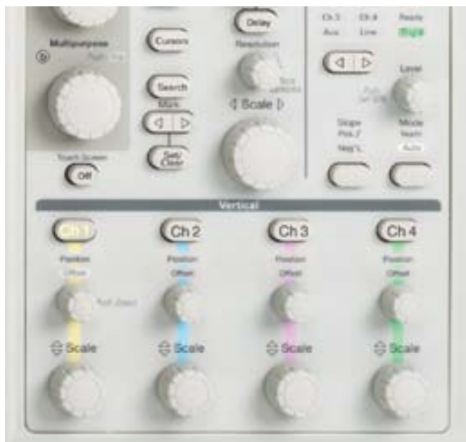
Рис. 59. Передняя панель с органами управления, характерными для аналогового осциллографа – всё знакомо ещё по учебникам.
