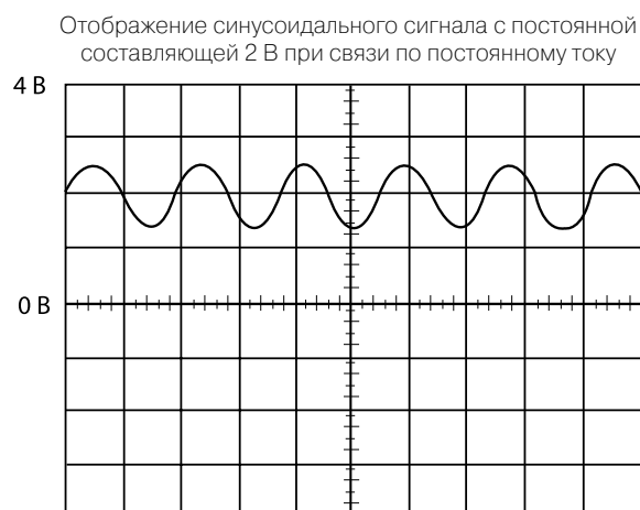
Рис. 20. Связь входа по постоянному и по переменному току.
