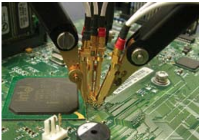
Рис. 40. Прецизионные пробники очень важны для измерения высокочастотных сигналов и импульсов с крутыми фронтами, свойственных современным компьютерным шинам и линиям передачи данных.
