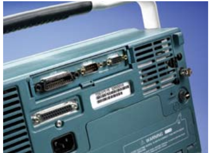
Рис. 52. Современные осциллографы предлагают широкий выбор коммуникационных интерфейсов, таких как стандартный порт Centronics или опциональные модули Ethernet/RS-232, GPIB/RS-232 и VGA/RS-232. Есть даже порт USB на передней панели (на рисунке не показан).
