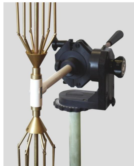
Фотографии 6 и 7. На примере антенны П6-121 с узлом крепления на диэлектрическом штативе (ШАД-01)
