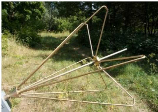
Фото 4. Антенна П6-121 на стадии сборки
