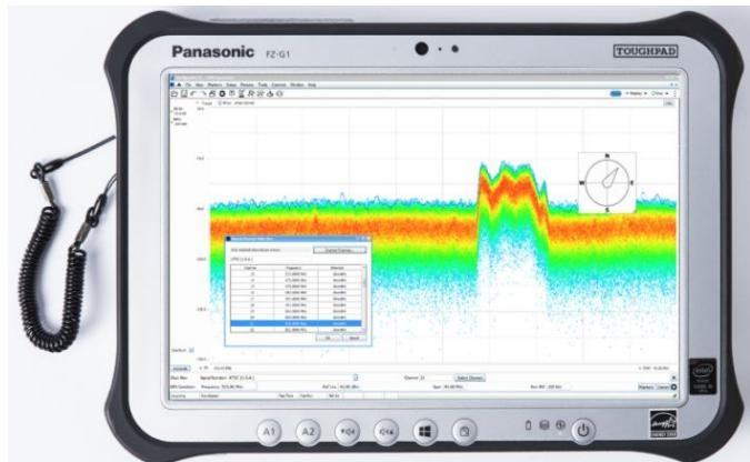
Приобретаемый у Tektronix планшет FZ-G1 имеет установленное ПО SignalVu-PC, а также специальные настройки экрана и кнопки передней панели для оптимизации работы с SignalVu-PC.
