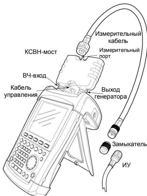
Анализатор R&S FSH с KCBH-мостом R&S FSH-Z3
