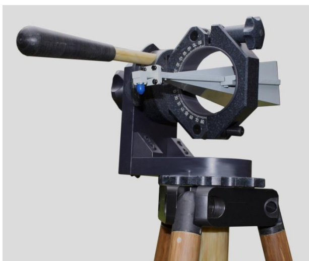
Фото 3. Антенна П6-132 на диэлектрическом штативе (ШАД-01)
