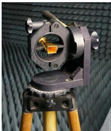
**Фото 1.** Антенна П6-135 на диэлектрическом штативе ШАД-01
