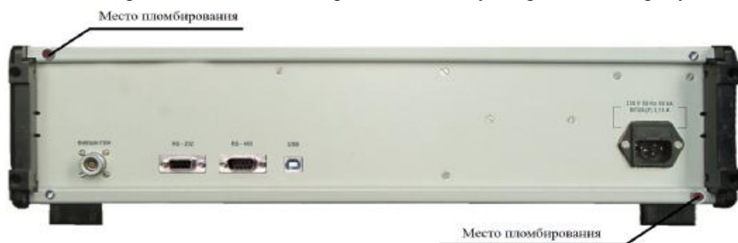
Рисунок 2 – Схемы пломбировки от несанкционированного доступа.
