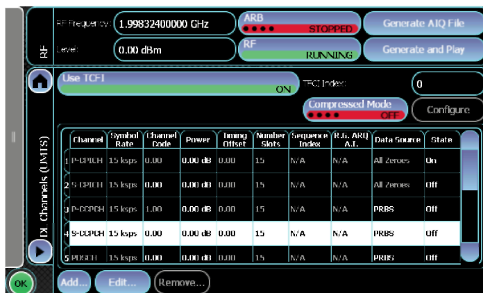
Конфигурация канала в нисходящем направлении (DL) системы UMTS в генераторе SGD
