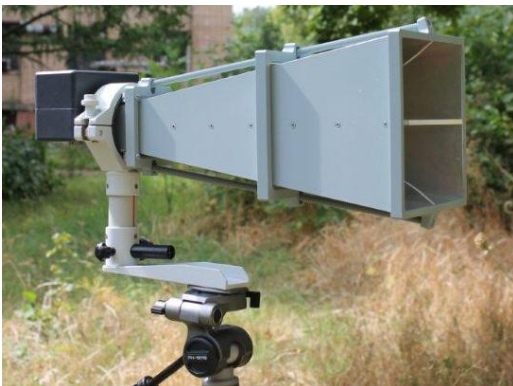
Фото 1. Антенна П6-126 на узле крепления АК-02
