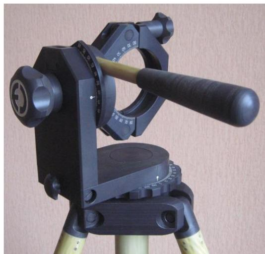
**Фото 3.** Устройство ориентации и фиксации ШАД-01
