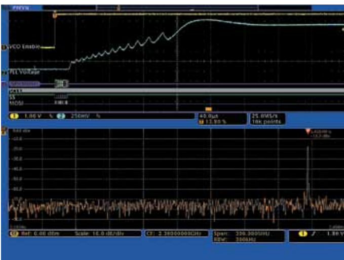
Рис. 4. Индикатор ST перемещён ещё на 120 мкс вправо. В этой точке спектр сигнала свидетельствует о том, что ФАПЧ фактически «проскочила» заданное значение частоты, значение которой теперь равно 2,4164 ГГц.
