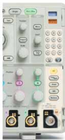
Рис. 8. Основные параметры спектра могут быть быстро настроены с помощью специализированных органов управления на передней панели.
