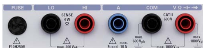
Abb. 1.3: Anschlüsse auf der Gerätevorderseite
