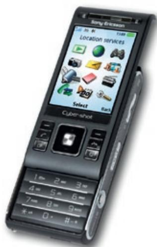
TEMS Pocket Remote выполняет измерения автоматически. Тестирование проводится незаметно, ведется запись данных в фоновом режиме при совершении пользователем вызовов (пассивное тестирование). Тестирование может запускаться пользователем или устройством (активное тестирование) с минимальным участием пользователя.
