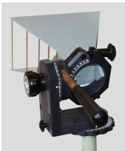
Фото 4 и 5. Антенна П6-123 и П6-140 из состава антенного измерительного комплекта АИК 1-40 Б/01
