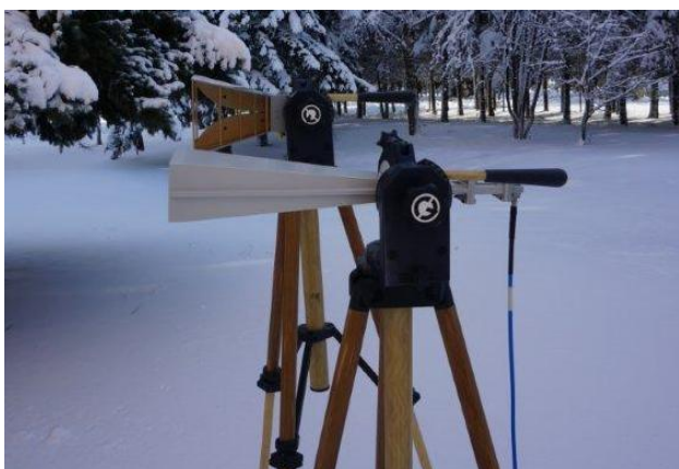
Фото 2. Антенный измерительный комплект на диэлектрических штативах ШАД-01
