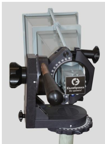
Фото 3. Антенна П6-124 на диэлектрическом штативе (ШАД-01)
