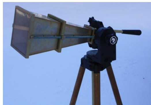
Фото 4. Антенна П6-124 на диэлектрическом штативе (ШАД-01), во влагозащитном исполнении
