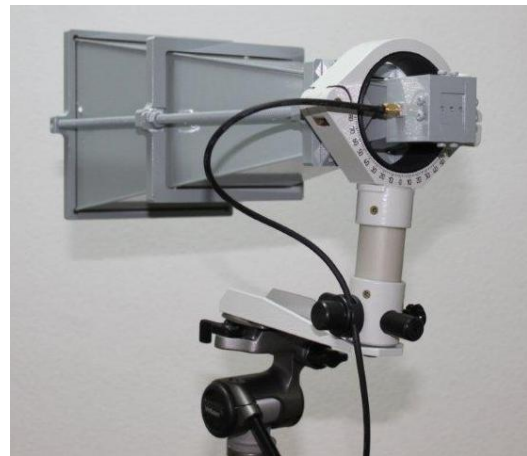
Фото 2. Антенна П6-124 узле крепления АК-02М
