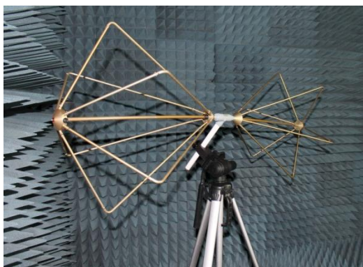
Фото 1. Антенна П6-121М1 на стандартном фотоштативе
