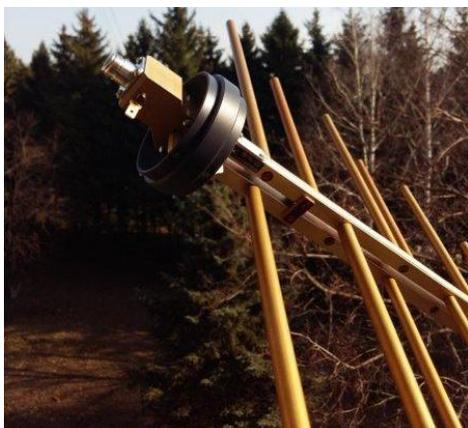
**Фото 3.** Антенна П6-122 с разъемом
