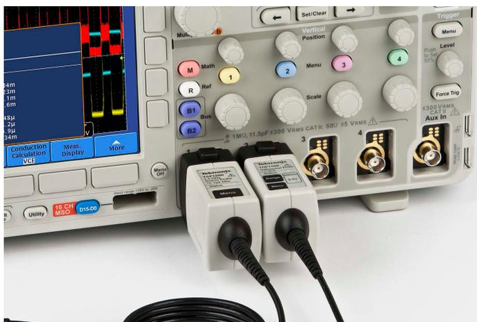
Интерфейс пробников TekVPI упрощает подключение пробников к осциллографу.
