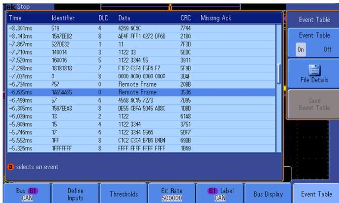
Таблица событий отображает декодированные идентификатор, DLC, данные и контрольную сумму (CRC) для каждого пакета шины CAN при долговременном измерении.
