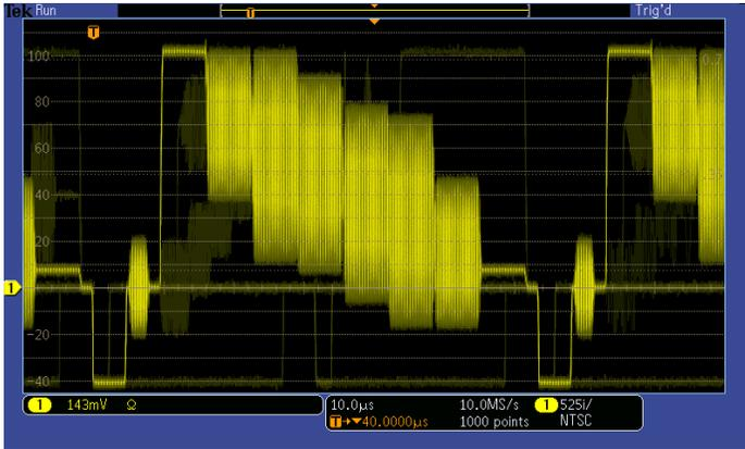
Исследование видеосигнала NTSC. Обратите внимание, что создаваемое осциллограммой DPO изображение с градациями яркости позволяет отобразить длительность сигнала, амплитуду и распределение амплитуды во времени.
