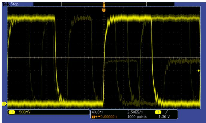
Обнаружение: захват сигнала с высокой скоростью — более 50 000 осциллограмм в секунду — максимально повышает вероятность обнаружения кратковременных глитчей и других редко происходящих событий.
