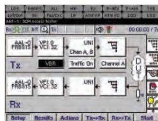
Рисунок 9: Структура сигнала ATM
