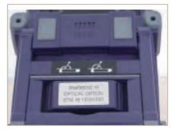
Рисунок 6: Вид верхней части прибора с отображением электрических и оптических интерфейсов.
