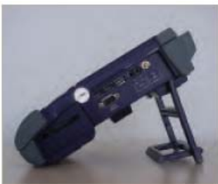
Рисунок 3: Вид прибора справа, на котором отображены порты карты CF, RS-232, T1 Bantam и порты ECL/NRZ
