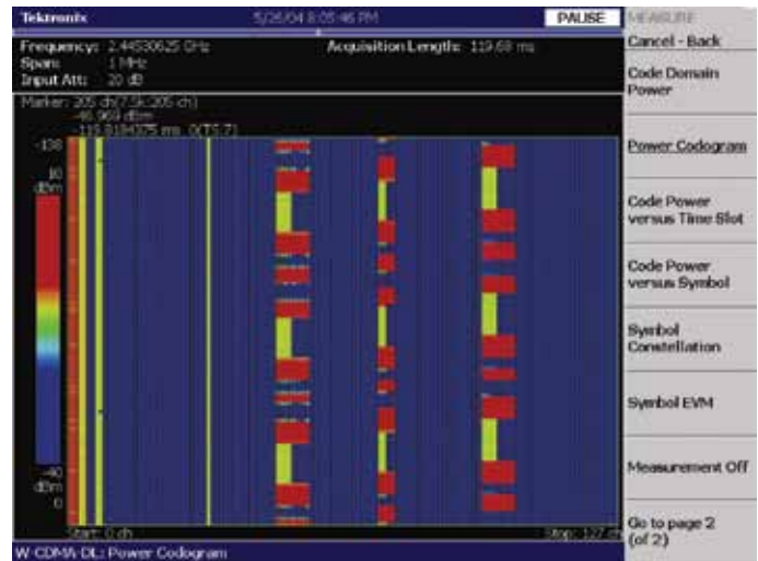
Рис. 3-20. Измерение кодограммы уплотненного сигнала W-CDMA.
