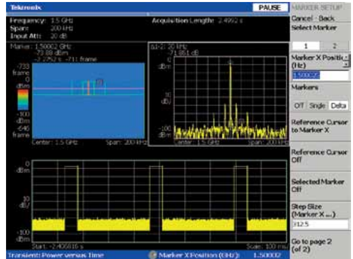
Рис. 3-24. Представление в нескольких областях с отображением спектрограммы, зависимости мощности от частоты и зависимости мощности от времени.
