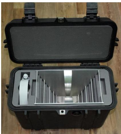
**Фото 3.** Антенна П6-123 в пыле-влажносто-защитном противоударном корпусе
