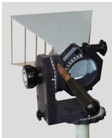
**Фото 4.** Антенна П6-123 на диэлектрическом штативе (ШАД-01)
