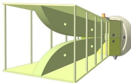
**Рис. 2** 3D модель антенны П6-123
