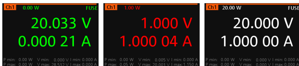
Рис. 5-3: Цветовая кодировка различных рабочих состояний
