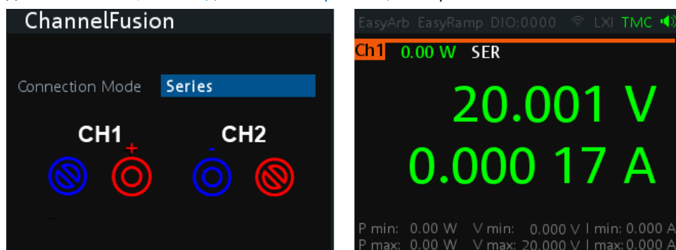
Рис. 6-4: Настройка режима последовательного подключения и выход одноканального отображения
