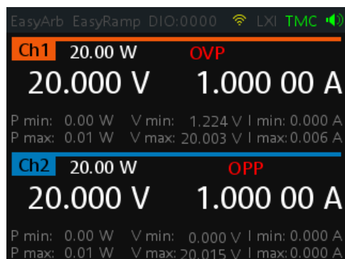
Рис. 6-8: Индикатор OVP/OPP при срабатывании
