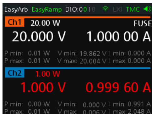
Рис. 6-3: Выход Ch2 в режиме CC
