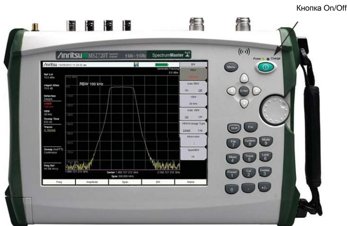
Рисунок 2-1. Кнопка включения/выключения MS2720T
