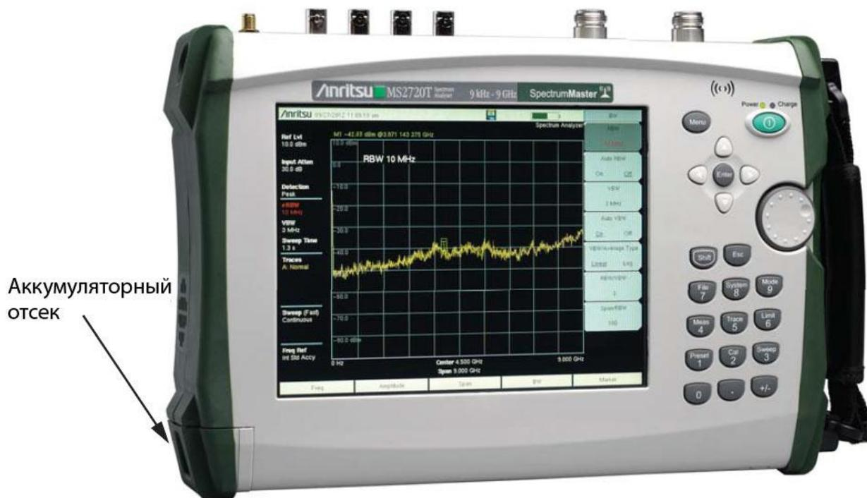
Рисунок 1-1. Аккумуляторный отсек
