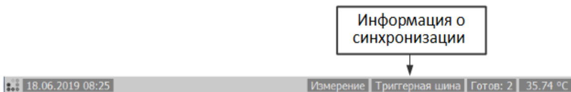
Рисунок 10.2 Пример строки состояния при работе с несколькими рефлектометрами
