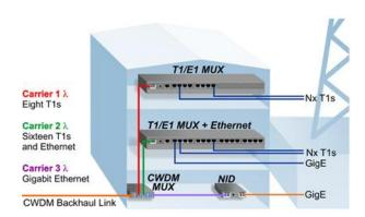
CWDM-мультиплексоры iConverter обеспечивают подключение нескольких операторов беспроводной связи к мачте сотовой связи через одну жилу оптоволоконного кабеля.
