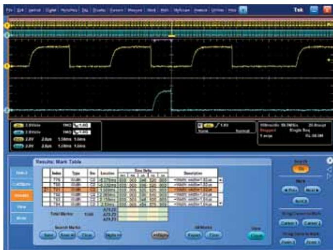
Шаг поиска 2. Wave Inspector осуществляет автоматический поиск по записи и отмечает каждое событие маркером в виде треугольника. После этого при помощи кнопок **Previous** (назад) и **Next** (вперед) можно перемещаться от одного события к другому.
