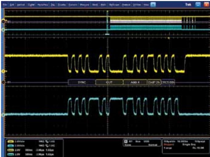
Запуск по пакету OUT Token высокоскоростной последовательной шины USB. Шинное отображение сигнала включает декодированное содержимое пакета, в том числе Start (пуск), Sync (синхронизация), PID, Address (адрес), End Point (конечная точка), CRC, Data values (значения данных) и Stop (стоп).
