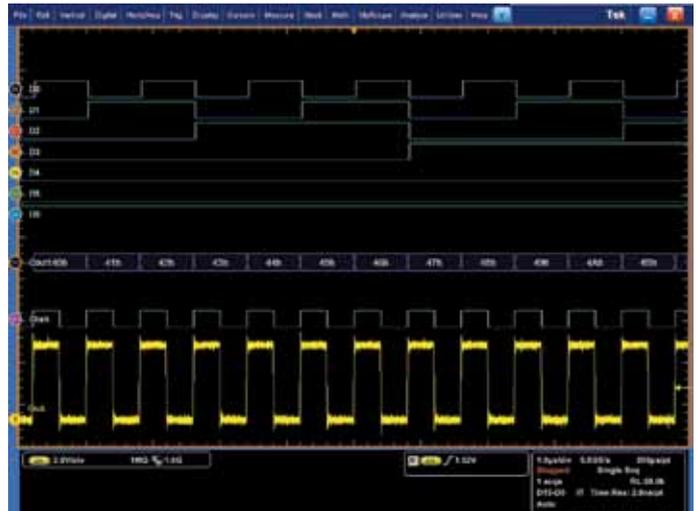
Цветовое кодирование логических состояний цифровых сигналов позволяет с легкостью определять уровни независимо от того, видны ли переходные процессы или нет. Зеленым цветом кодируются состояния логической «1», синим — логического «0». Значения пороговых напряжений для цифровых сигналов можно устанавливать для каждого канала, обеспечивая возможность работы с 16 различными логическими элементами.
