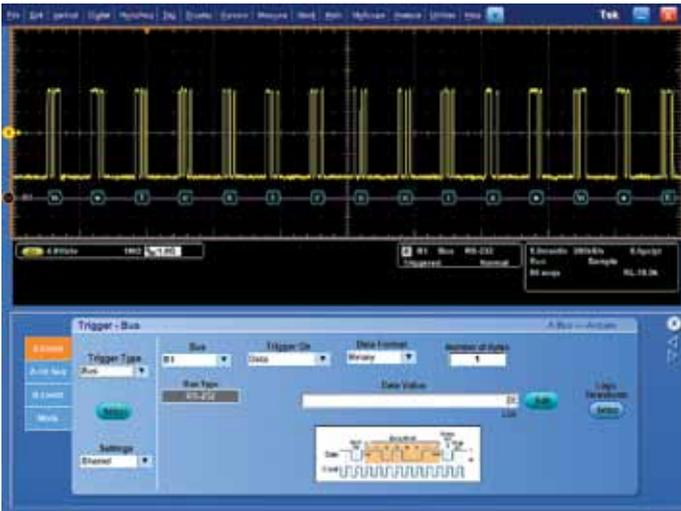
**Захват.** Запуск по определенному пакету данных на шине RS-232. Полный набор установок для системы запуска, включая содержимое пакетов последовательных шин, гарантирует быстрый захват интересующего события.
