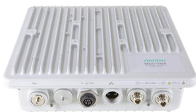
MS27102A имеет сертификацию IP67 и может эксплуатироваться вне помещений. Монитор имеет защиту от проникновения пыли и влаги и поставляется с монтажной пластиной для работы в полевых условиях. С помощью П-образных болтов и креплений (не входят в комплект поставки) монитор с монтажной пластиной может устанавливаться на мачтах различных диаметров.
