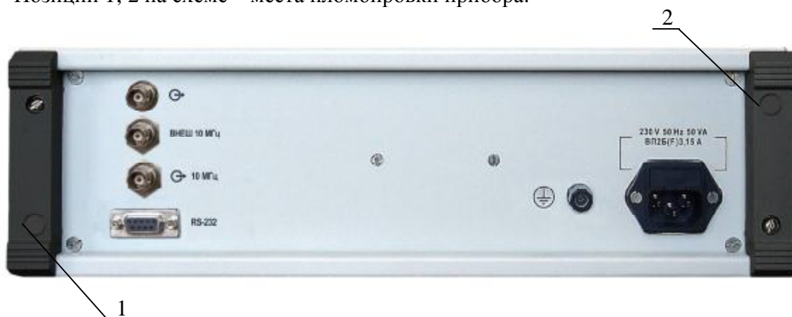
Рис. 2 Схема пломбировки прибора.
