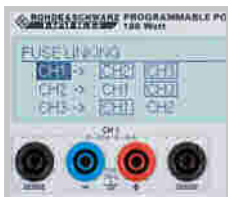
Индивидуально связываемые электронные предохранители посредством FuseLink
