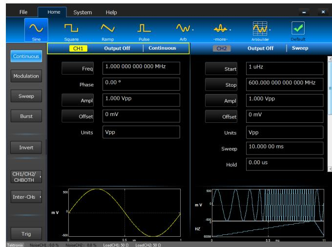
В расширенном режиме пользователь может создавать сложные сигналы, последовательно вводя до 16 384 элементов аналоговых сигналов и цифровых кодов, используя в последовательности бесконечные циклы, переходы и условные ветвления.
