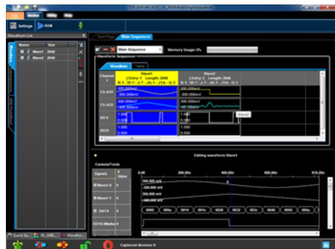
В режиме независимых последовательностей можно задать две отдельные последовательности для канала 1 и канала 2 (и соответствующих цифровых каналов), как для двух независимых генераторов.
