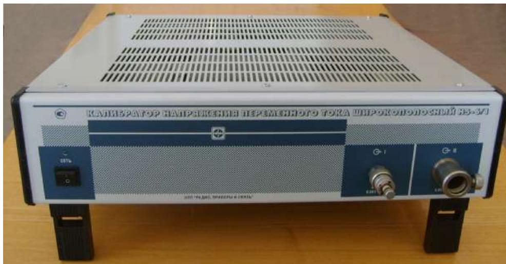
Рисунок 1 - Внешний вид калибратора напряжения переменного тока широкополосного Н5-6/1 (без ПК)
