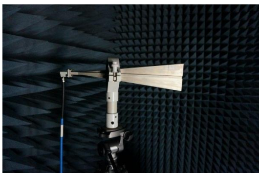
Фото 1. Антенна П6-131 на узле крепления АК-02М
