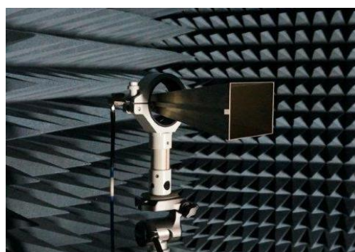
Фото 2. Антенна П6-131 на узле крепления АК-02М
