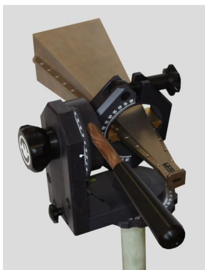
Фото 1. Антенна П6-131 на узле крепления АК-02М
