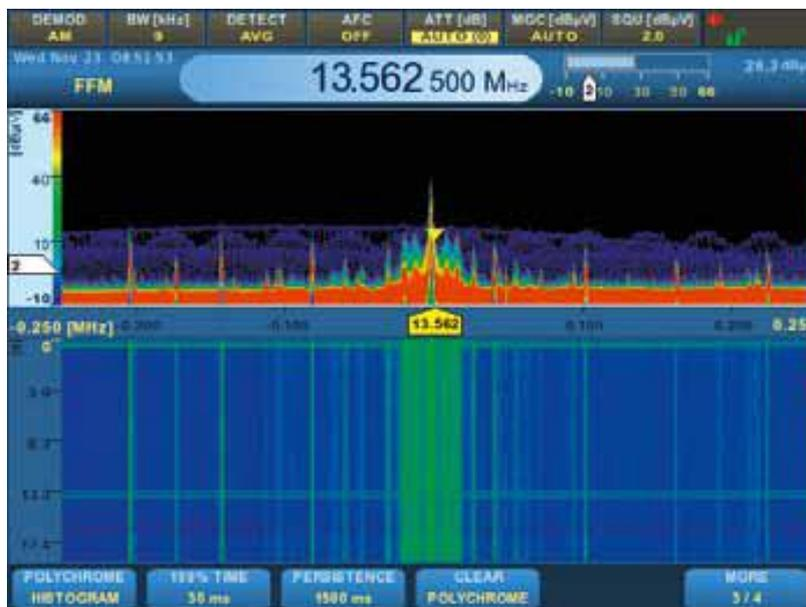
Рис. 4-2. R&S®EB510, полихромный режим. Импульсная помеха источника питания.
