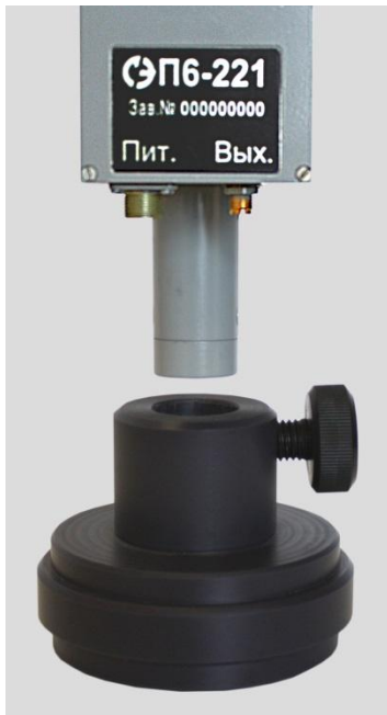
Фото 4. Антенна П6-221 и узел крепления
