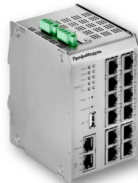
Промышленные контроллеры производятся в исполнении IP40 и IP54, прошли испытания на ЭМС, что позволяет их эксплуатировать в телекоммуникационных шкафах, размещенных в контейнерах и на удаленных объектах связи
