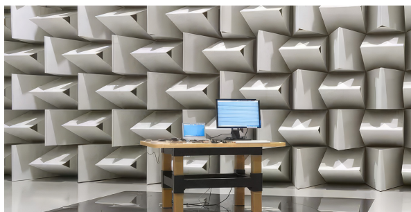
Акустические (заглушенные) камеры по стандартам ISO 3744 и 3745. Испытательные стенды NVH тестирования автомобилей и автокомпонентов
